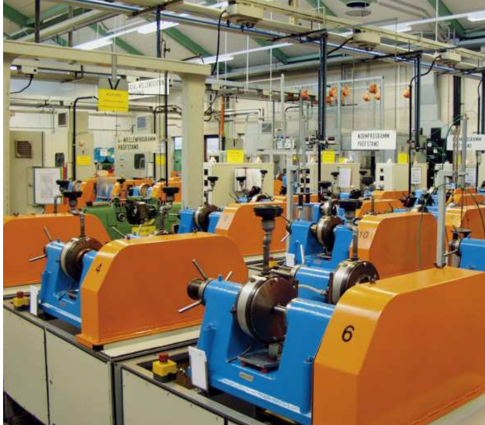
Le stazioni di prova degli anelli di tenuta presso la sede di Simrit dispongono oltre che di banchi di prova standard anche di svariati dispositivi speciali.
