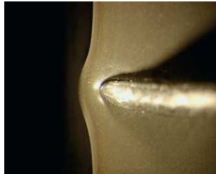
Labbri di tenuta di un Simmering dopo un ciclo di prova con un materiale FKM standard (sopra, con formazione di screpolature alla spatolatura) e un materiale BRE-FKM 75 FKM 260507.
