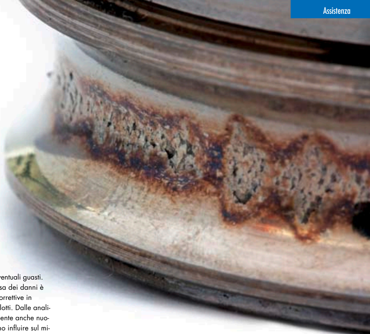
Fig. 3: l'assenza di lubrificazione dei cuscinetti a sfera ha provocato il caso di sinistro.
