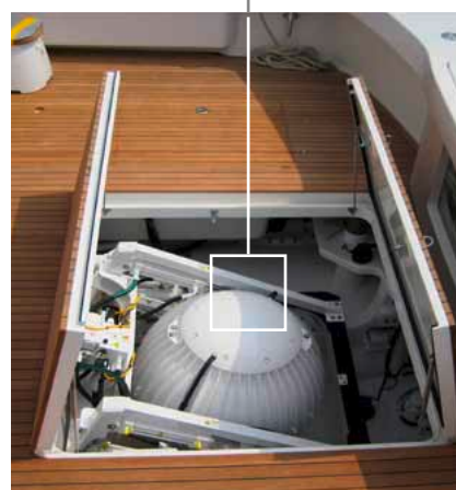
I giroscopi sono in grado di attutire i movimenti di rollio e serpeggiamento di una nave.
