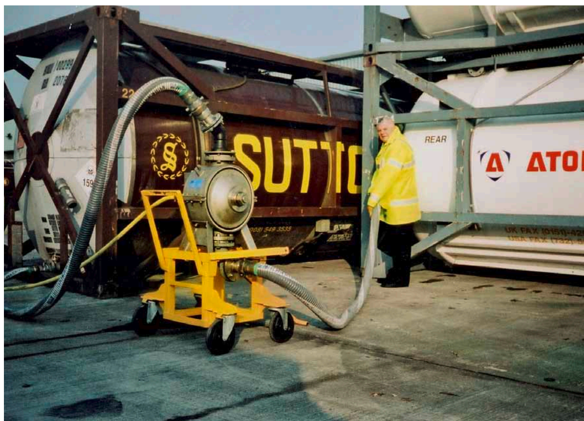
La pompa gestisce diversi liquidi, ad es. il gasolio. Può svuotare cisterne da 30.000 litri in meno di due ore.
